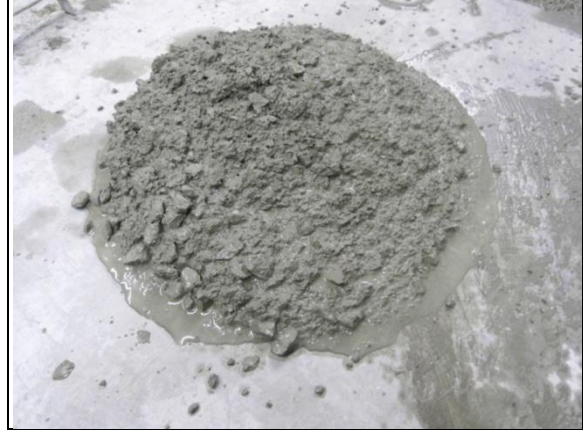
Şekil 11. W/C oranı 0,67 ve kalker tozu oranının % 9 taze betonda ince agreganın iri agregadan ayrışma durumu
