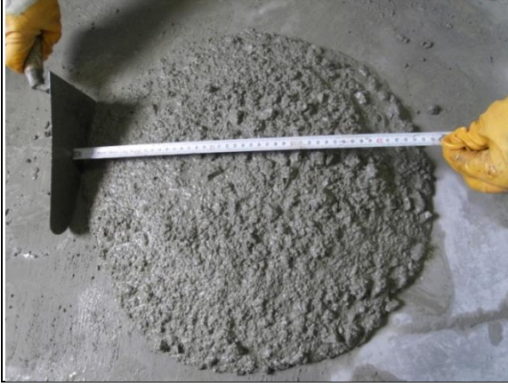
Şekil 10. W/C oranı 0,67 ve kalker tozu oranının % 15 taze betonda homojen ve ayrışma olmadan yayılma
